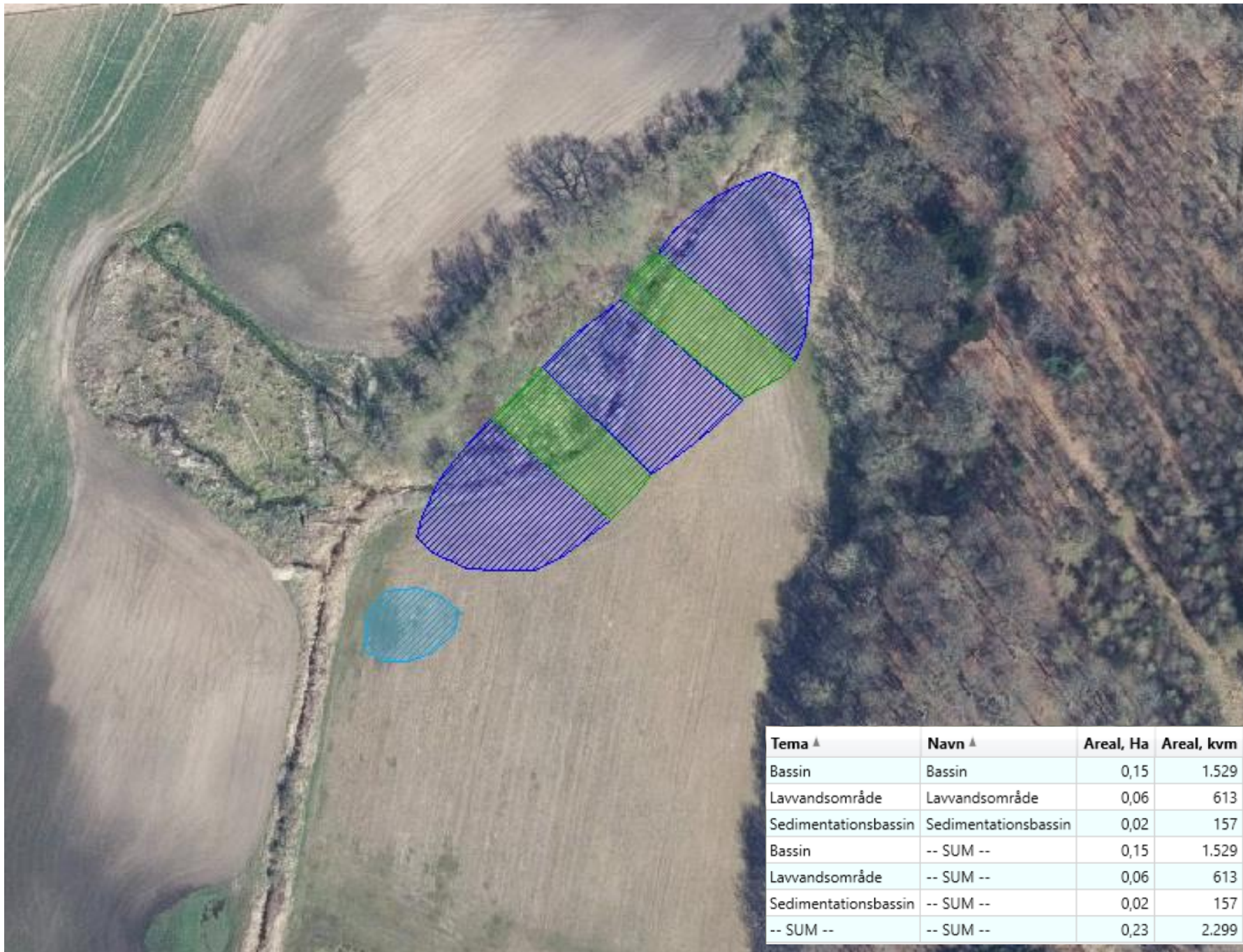
Kortbilag 2: Minivådområdet er skraveret, og de forskellige bassindybder er angivet. De mørkeblå områder er de dybe områder, de grønne områder er lavvandsområderne og det lyseblå område er sedimentationsbassinet. Vandspejlet bliver ca. 0,78 ha.
